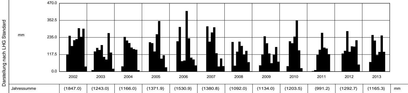
Ab 1. Mai 2007 Logger-Aufzeichnung mit Kippwaage (erhöhte Messgenauigkeit)
