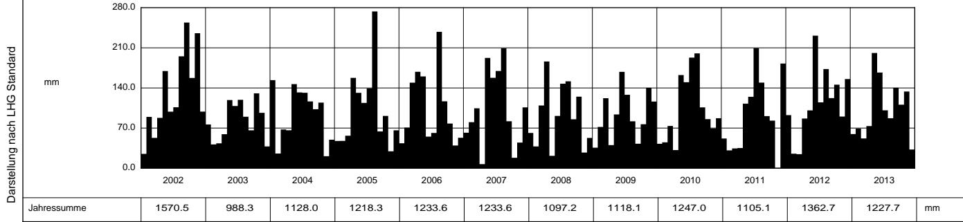
Ab 14. Juni 2001 Logger-Aufzeichnung mit Kippwaage und geheiztem Auffanggefäß
