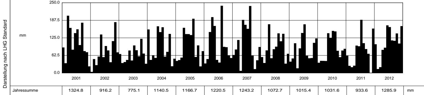
Ab 24. Nov. 2003 Logger-Aufzeichnung mit Kippwaage und geheiztem Auffanggefäß
